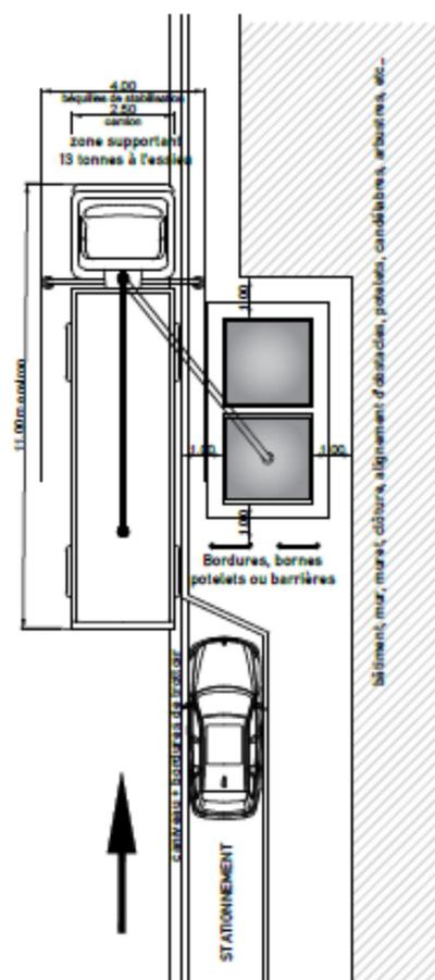
\*Lorsque la collecte doit s'effectuer sur des voies dont la largeur ne permet pas le déploiement des béquilles de stabilisation sur la chaussée (exemple : largeur de voie de 3.50 m), les béquilles pourront reposer sur le trottoir dans la mesure où celui-ci peut en supporter la charge et où il pourra être respecté les distances minimales nécessaires à la manipulation de la grue et au soulèvement du conteneur ; à savoir, un minimum de 1.00 m entre le bord du conteneur et le bord du véhicule.
